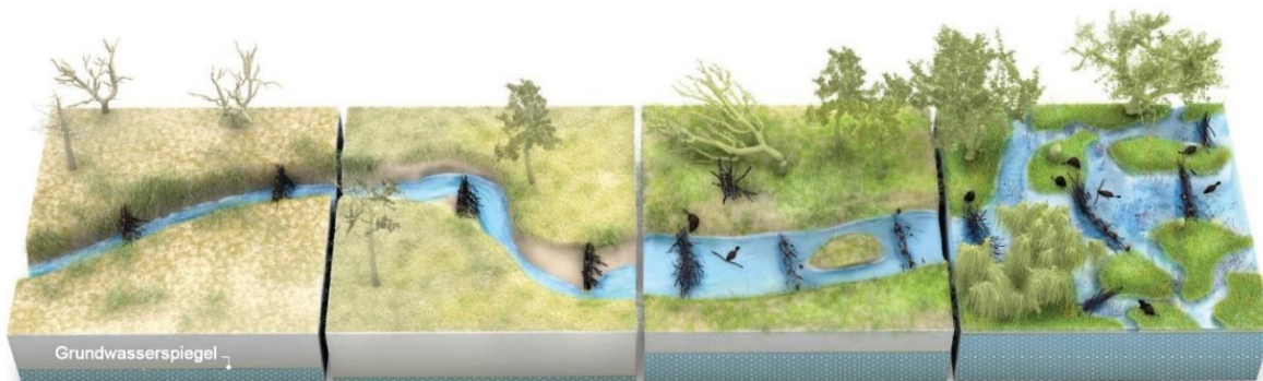
Fig. 25 : « Un ruisseau retrouve la vie ». Aux États-Unis, les BDA sont utilisés pour revitaliser les cours d'eau et rétablir des populations de castors. De gauche à droite : 1) Construction de BDA sur des cours d'eau incisés. 2) Les BDA détournent le courant, ce qui provoque une érosion des berges et un élargissement du cours d'eau. 3) Le castor colonise la zone et construit d'autres barrages. Le niveau de la nappe phréatique s'élève. 4) Le castor crée un réseau dynamique de milieux naturels, comme on peut le voir par exemple sur les figures 23 et 24 (illustration : © Science, V. Altounian in Goldfarb, 2018).
